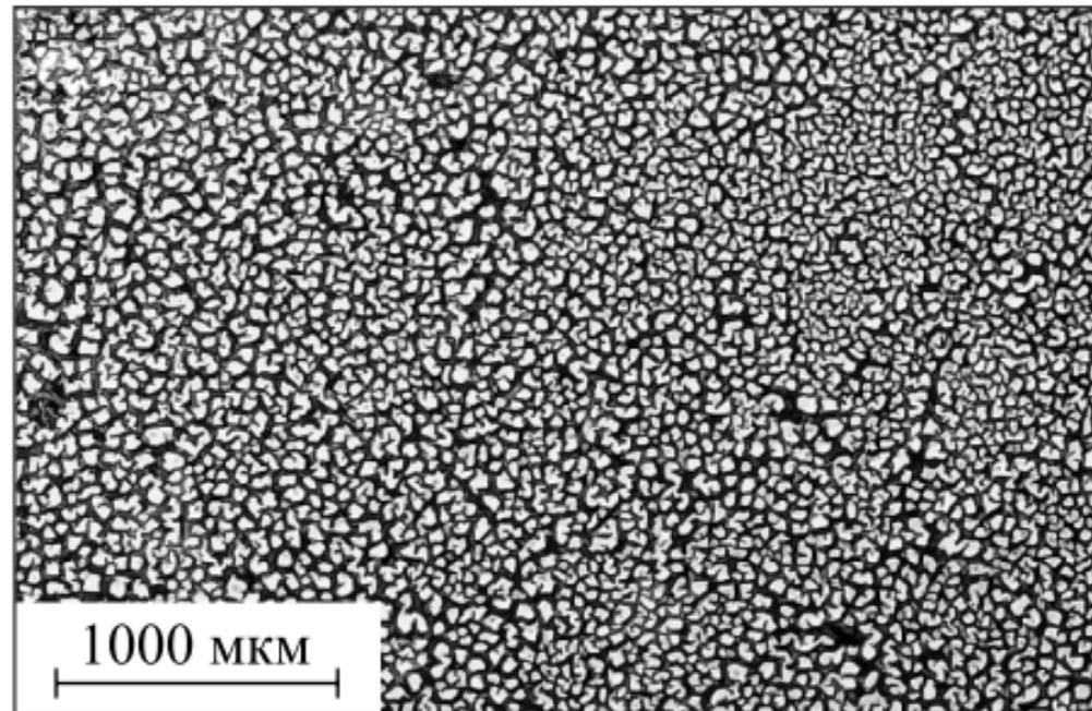
*Рис. 1.* Поверхности пленок на образцах 3 и 6, сформированных из суспензий с максимальной концентрацией тиокарбамида
