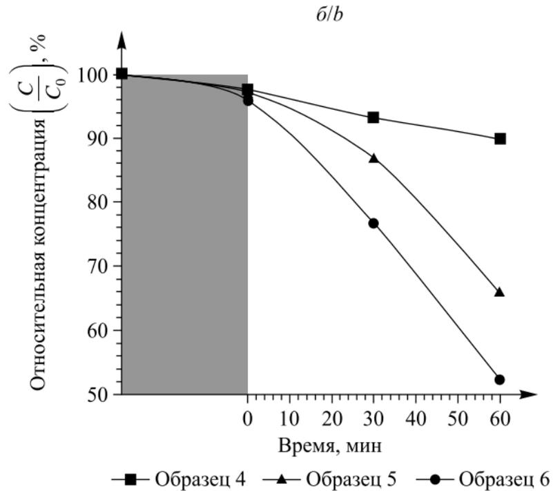
*Рис. 3.* Кинетика разложения родамина Б в водном растворе при экспонировании УФ-излучением (длина волны 365 нм) в присутствии образцов  $\text{TiO}_2 - \text{Si}$ , сформированных отжигом при температуре 550 °C (*а*) и 850 °C (*б*). Область темновой выдержки (30 мин) отмечена серой заливкой
