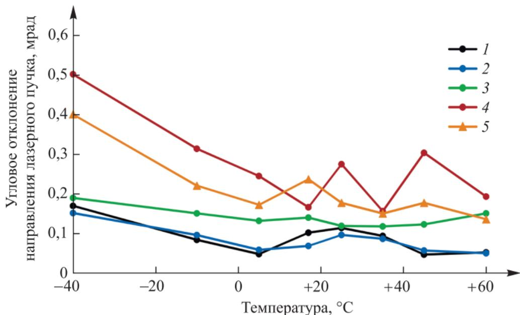
Рис. 8. Экспериментально полученная зависимость угловых отклонений направления лазерного пучка относительно усредненного положения центра масс для частот следования импульсов 4,0 Гц от температуры:
