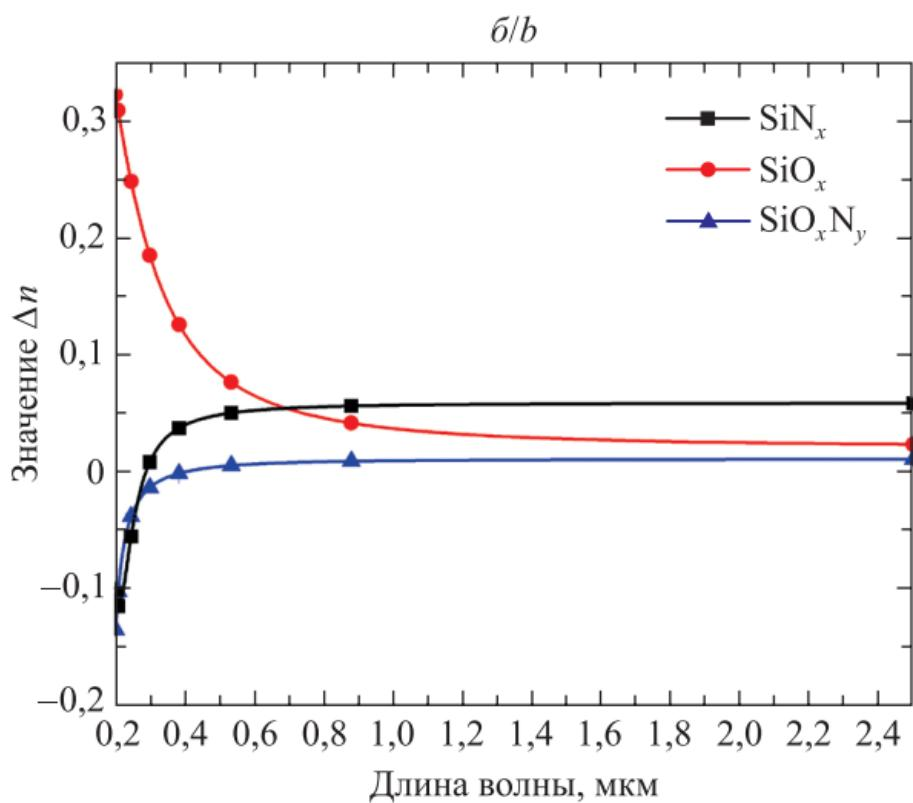
Рис. 2. Дисперсия показателя преломления (*a*) и разность спектров (*b*) образцов  $\text{SiN}_x$ ,  $\text{SiO}_x$ ,  $\text{SiO}_x\text{N}_y$  до и после УФ-воздействия
