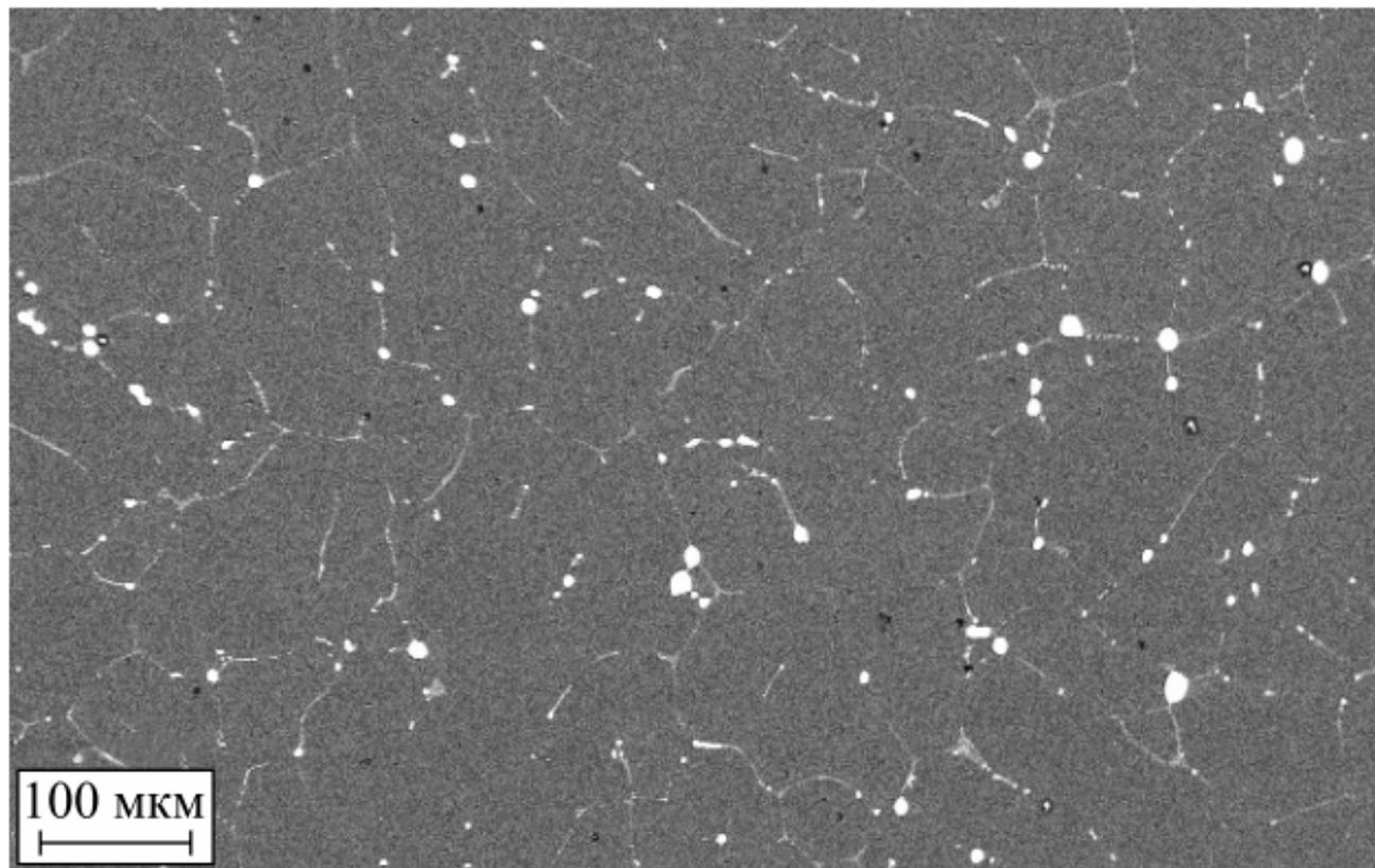
*Рис. 1.* Микроструктура сплава Al – 2,6 мас. % Bi
