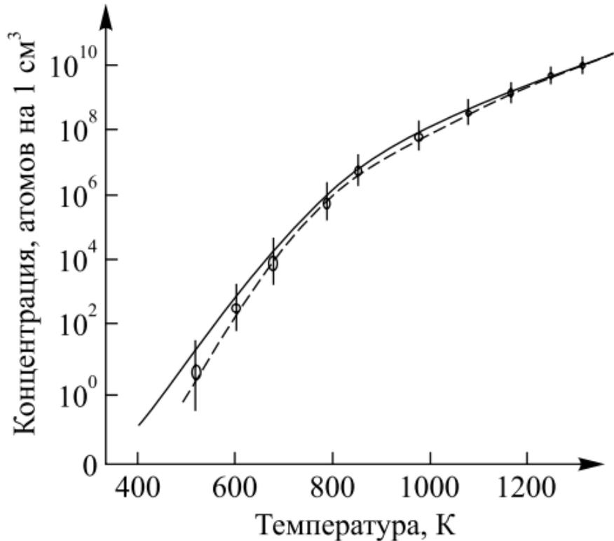
Рис. 6. Зависимость концентрации атомов индия от температуры тигля
