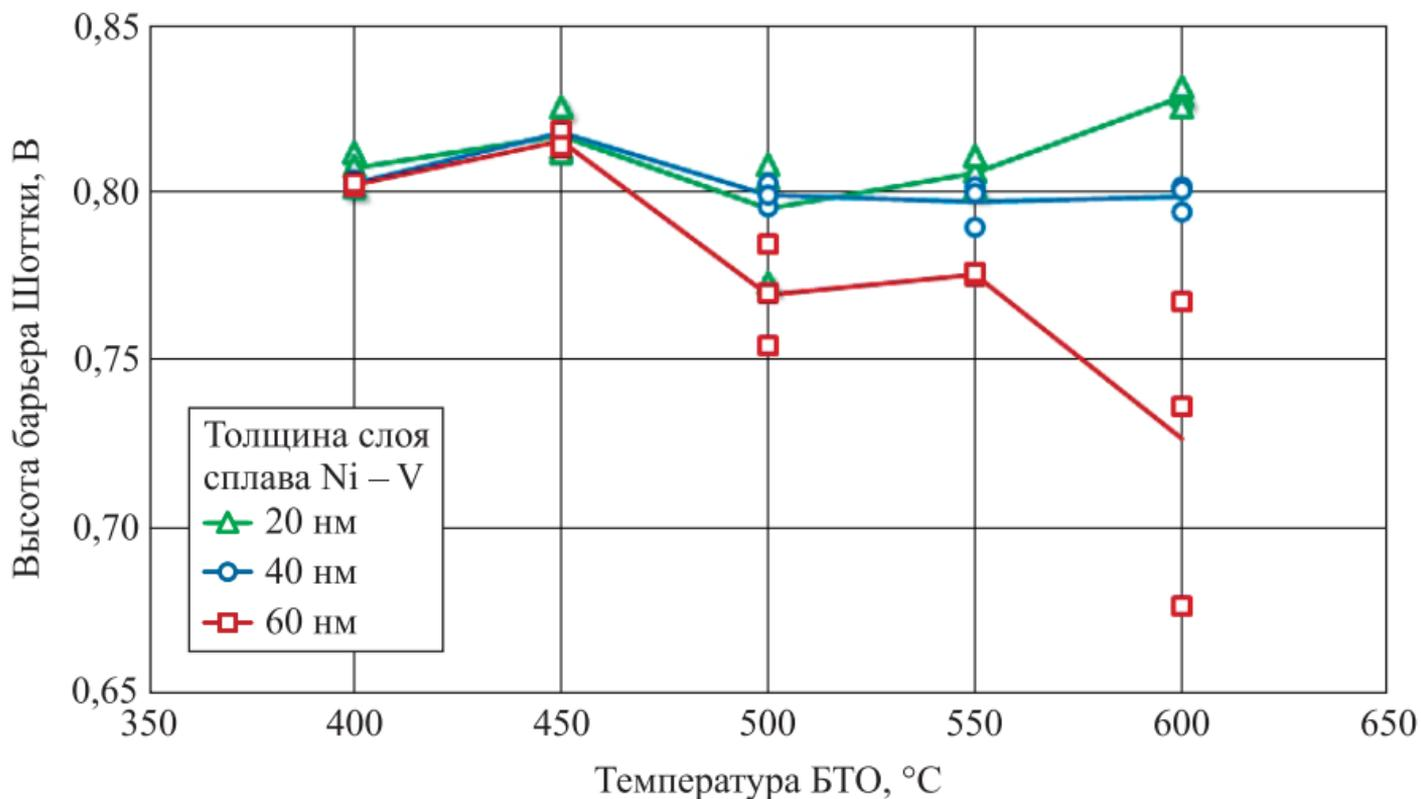
*Рис. 6.* Зависимость высоты барьера Шоттки структуры Ni – V/Pt/Si от температуры БТО при толщине слоя сплава Ni – V 20; 40 и 60 нм
