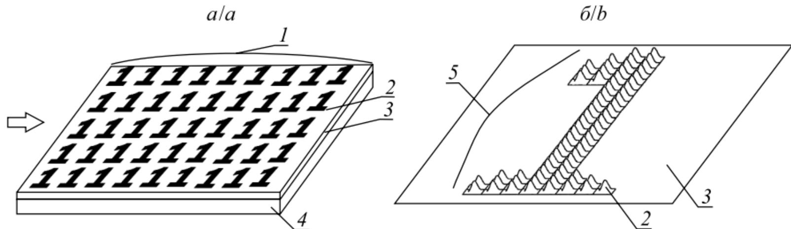
*Рис. 4.* Формирование микрорельефной структуры в форме решетки микроизображений в слое фоторезиста (а).
