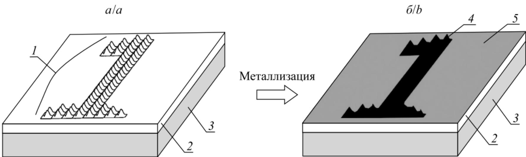
*Рис. 6.* Повышение контрастности структуры микроизображений на полимерной пленке методом металлизации поверхности полимера:
