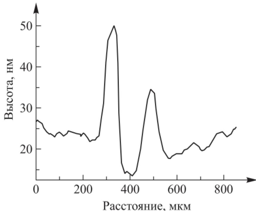
*Рис. 6.* Трехмерное АСМ-изображение конусовидного образования на поверхности стали, обработанной ЭП (*a*), и его профиль (*б*)
