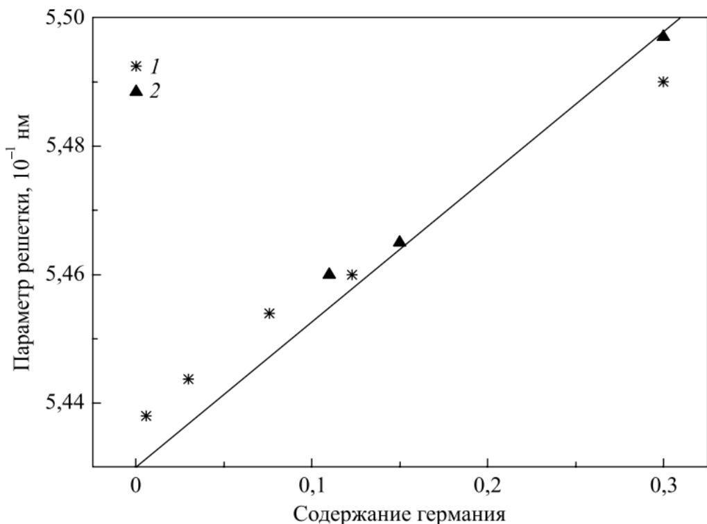
*Рис. 5.* Зависимость параметра решетки твердых растворов  $\text{Si}_{1-x}\text{Ge}_x$  от содержания германия (1 – расчетные данные; 2 – результаты рентгенофазового анализа). Сплошная линия соответствует зависимости Вегарда
