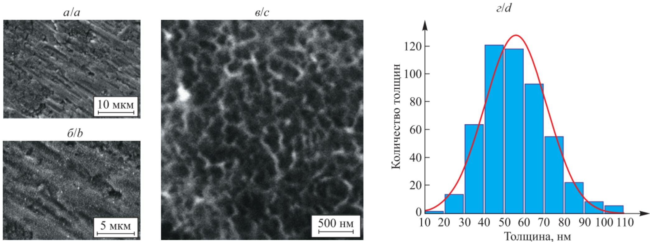
Рис. 2. СЭМ-изображения поверхности  $\text{TiO}_2/\text{Ti}$ , полученные при увеличении  $\times 7000$  (а),  $\times 15\,000$  (б) и  $\times 65\,000$  (в), и распределение толщин нанонитей оксидного слоя на поверхности титана (г)
