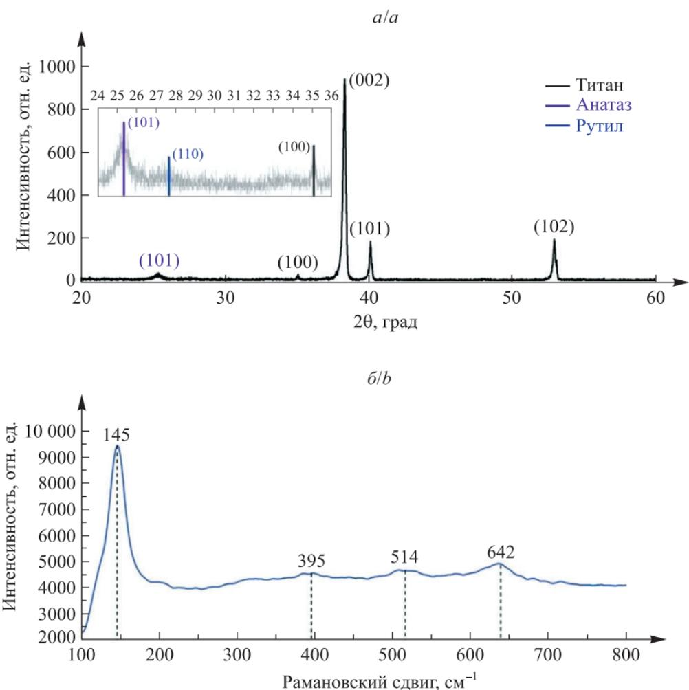
*Рис. 3.* Дифрактограмма гетероструктуры  $\text{TiO}_2/\text{Ti}$  (на вставке представлена дифрактограмма, полученная с шагом  $0,005^\circ$ ) (a) и спектры КРС  $\text{TiO}_2/\text{Ti}$  (б)
