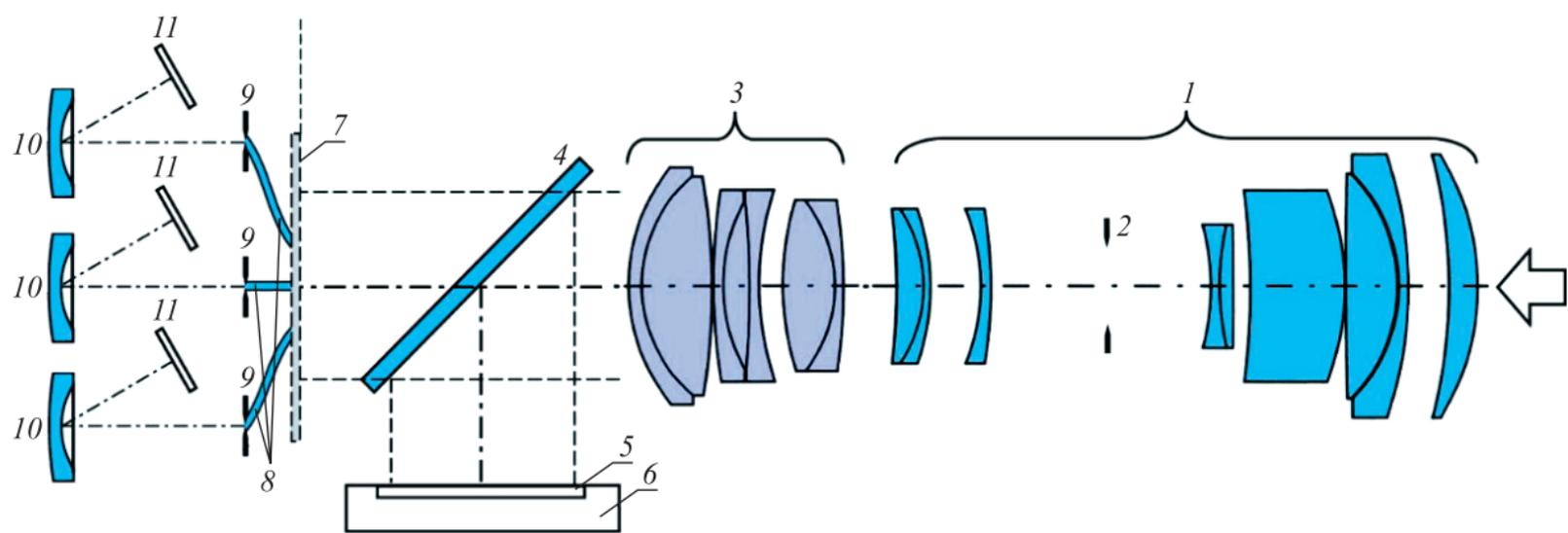
*Рис. 2.* Упрощенная оптическая схема НА «ВСС»:
