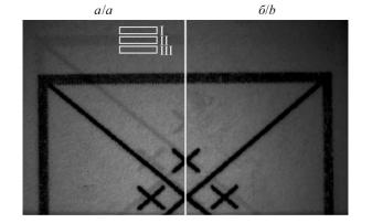
Рис. 15. Фотоснимок тестовой миры, полученный НА «ВСС»: a — часть изображения, не подвергавшаяся коррекции; 6 — часть изображения, для которой выполнено устранение призраков
