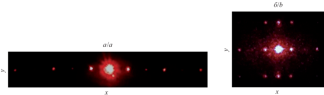
Рис. 5. Дифракционная картина одномерной (а) и двумерной (б) анизотропных фазовых ЖК-решеток
