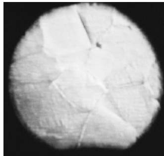
Рис. 2. Изменения полированной поверхности сплава \text{PdH}_{0.1} , вызванные инициацией прямого гидридного фазового превращения \alpha \rightarrow \beta путем повышения давления при T = 230^\circ\text{C} = \text{const} . Время от начала приповерхностных изменений: a – 0 с; б – 1 с; в – 4 с; г – 11 с; д – 25 с
