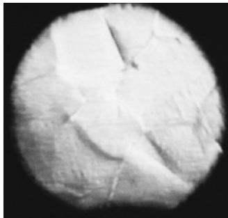
Рис. 2. Изменения полированной поверхности сплава \text{PdH}_{0.1} , вызванные инициацией прямого гидридного фазового превращения \alpha \rightarrow \beta путем повышения давления при T = 230^\circ\text{C} = \text{const} . Время от начала приповерхностных изменений: a – 0 с; б – 1 с; в – 4 с; г – 11 с; д – 25 с
