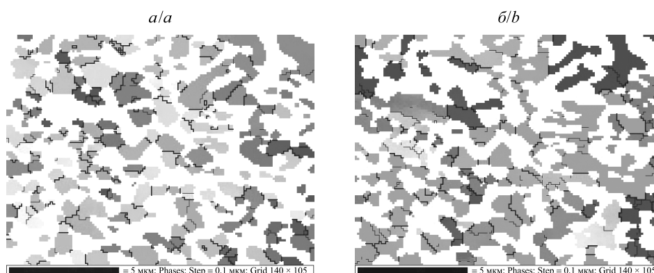
Рис. 3. Зеренная структура фольги быстрозатвердевшего сплава \text{Bi}_{34}\text{Sn}_{63}\text{Ag}_3 : a – фазы Bi; b – фазы \beta -Sn
