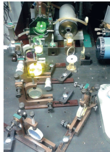
Рис. 2. Схема (а) и внешний вид (б) экспериментальной установки для зондирования наведенных потерь в этанольном растворе родамина 6Ж:
