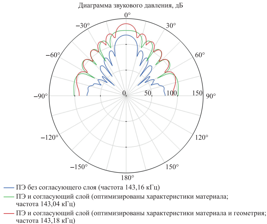
Рис. 5. Изменение диаграммы звукового давления
